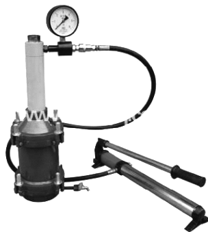
图 2-5 混凝土压力泌水仪
