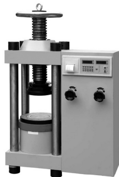
图 2-8 混凝土压力试验机
